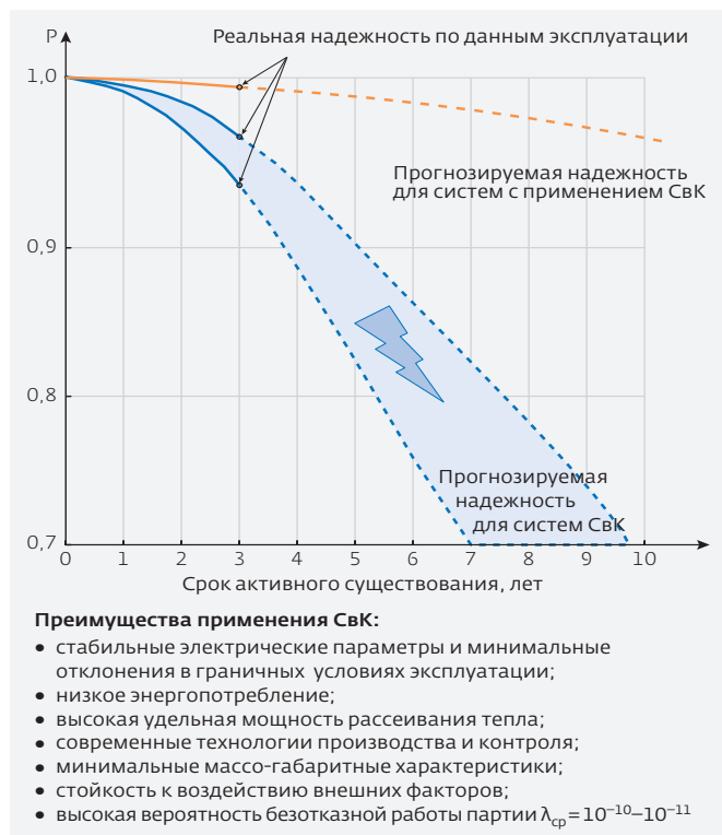
Рис.3. Эволюция надежности радиоэлектронных космических систем на базе применения СВК
